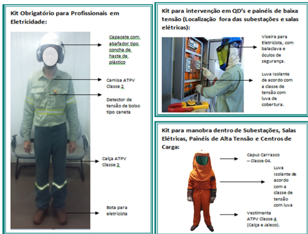
Imagem 8: EPI's obrigatórios para atividades em sistema elétrico
