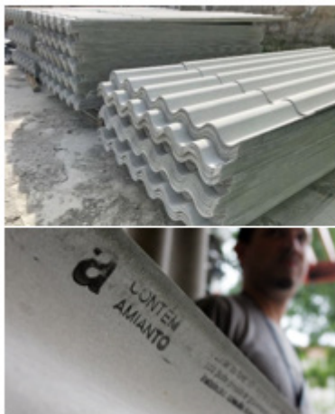
Figura/Imagem 11 –Asbesto não friável
