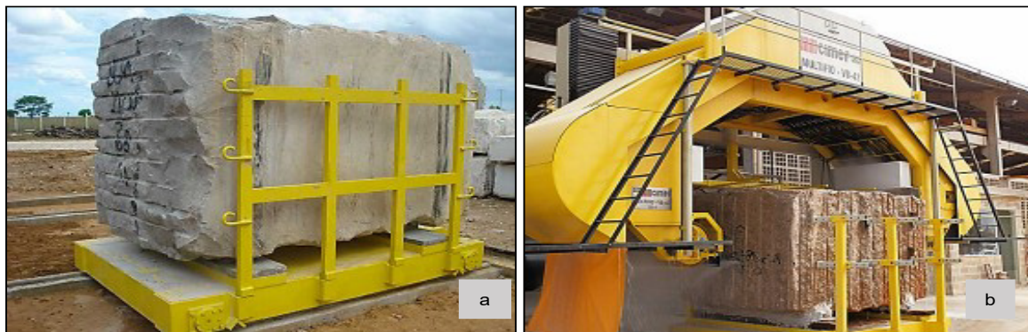
Figura 12 – Transporte do bloco: a) carro porta-bloco; b) bloco sobre quadro de lâminas do tear Fonte: http://www.cimef.com.br/imagens/produtos/td800_diamantado%287%29.jpg
