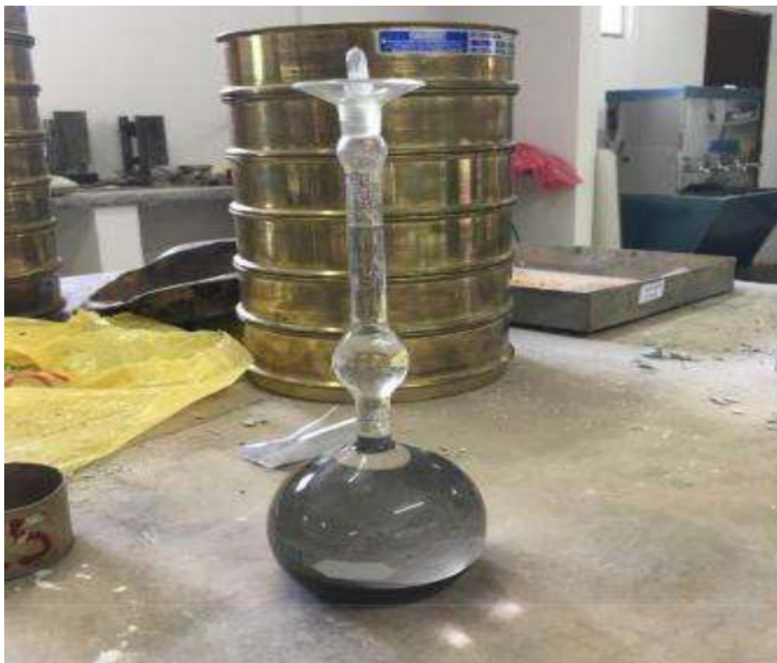
Foto 4 – Ensaio de peso específico dos aglomerantes. (Fonte: acervo do autor )
