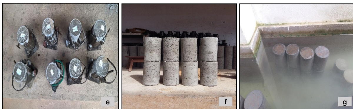
Figura 28 - Moldagem e cura dos Corpos de Provas Convencional Fonte: Autores (2016)
