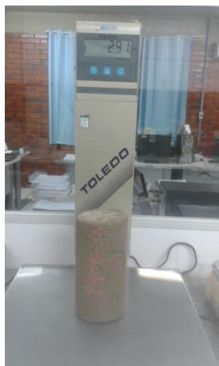
Figura 3: Pesagem de corpo de prova Fonte: Elaborado pelo autor, 2016
