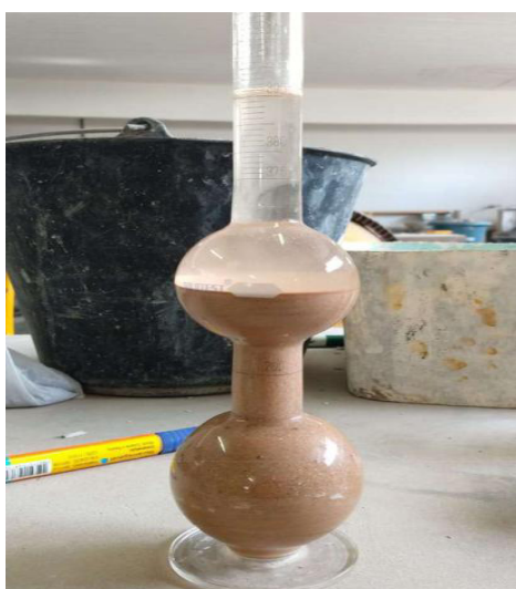
Figura 6: Realização do ensaio de massa específica da areia Fonte: Autor, 2018.
