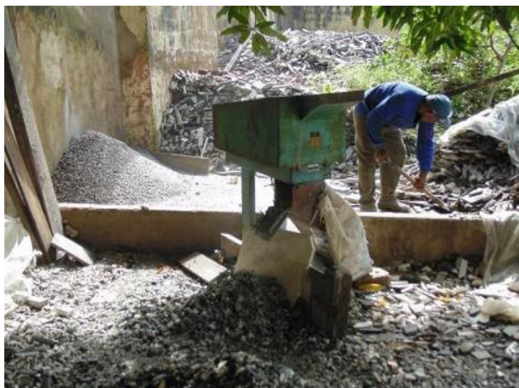
Figura 21 – Transformação do RCMG em agregado Fonte: Autores 2016
