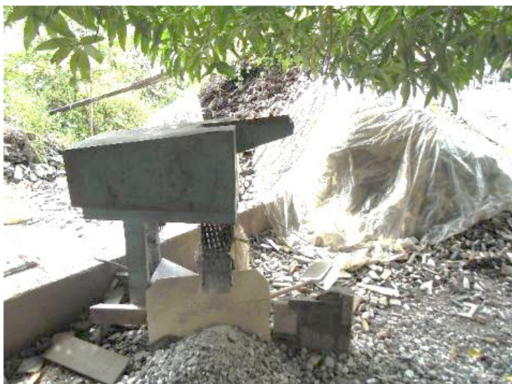
Figura 22 - Trituração dos Fragmentos Autor: Autores (2016)
