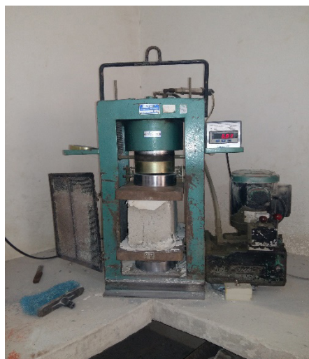
Figura 40 - Rompimento do bloco Autor: Autores: 2016
