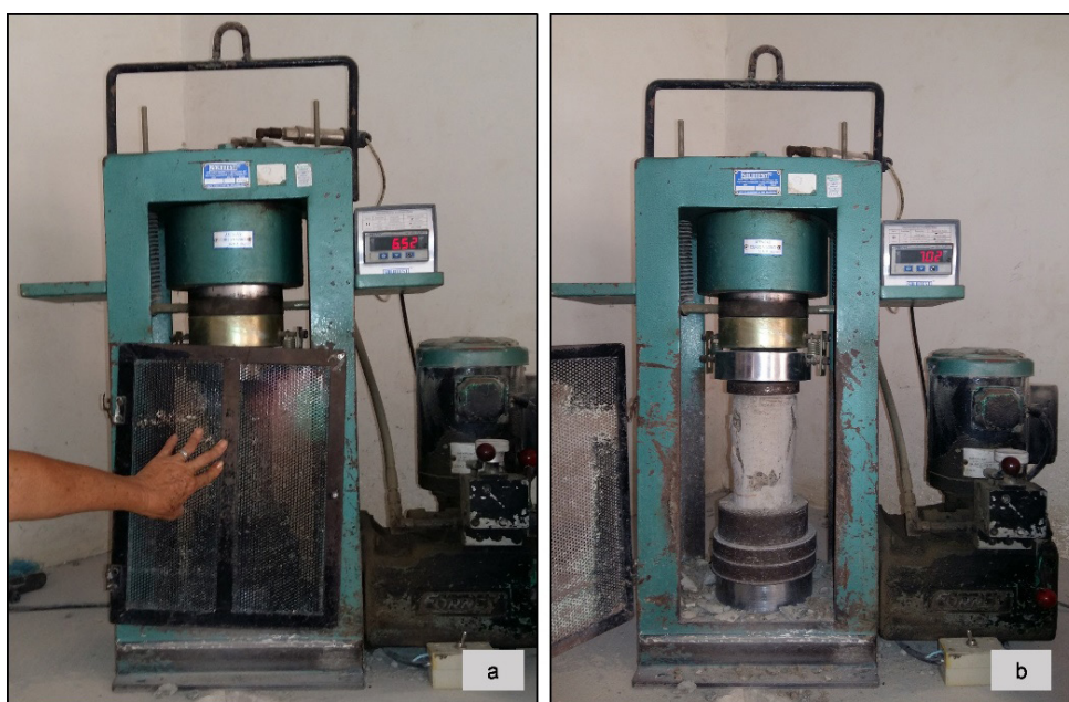
Figura 34 - Ensaio de Resistência a Compressão (Convencional – 28 dias) Fonte: Autores (2016)
