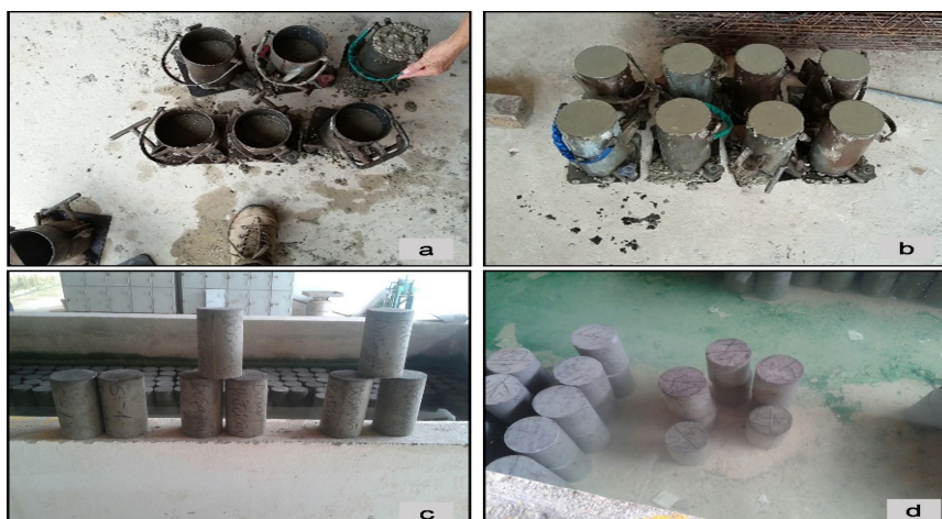
Figura 27 - Moldagem e cura dos Corpos de Provas - RCMG Fonte: Autores (2016)
