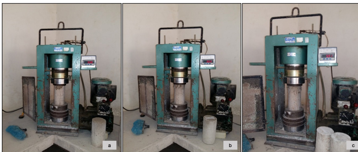
Figura 33 - Ensaio de Resistência a Compressão (Convencional – 21 dias) Fonte: Autores (2016)
