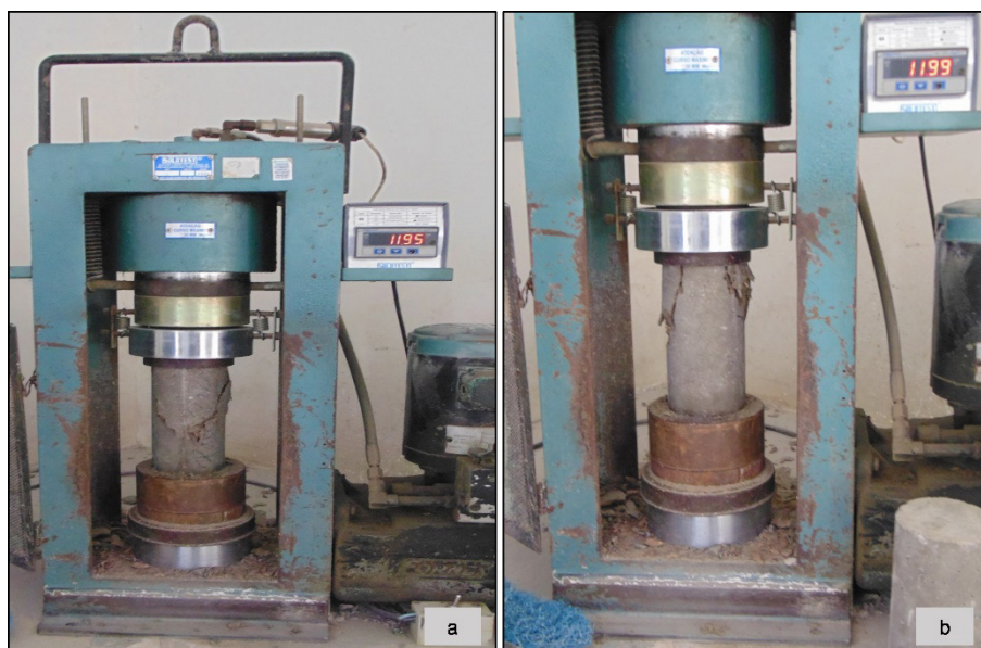
Figura 31 - Ensaio de Resistência a Compressão (RCMG – 28 dias) Fonte: Autores (2016)
