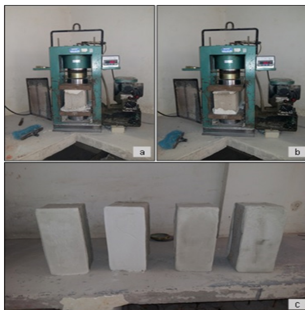
Figura 44 - Ensaio de resistência a compressão Autor: Autores:2016
