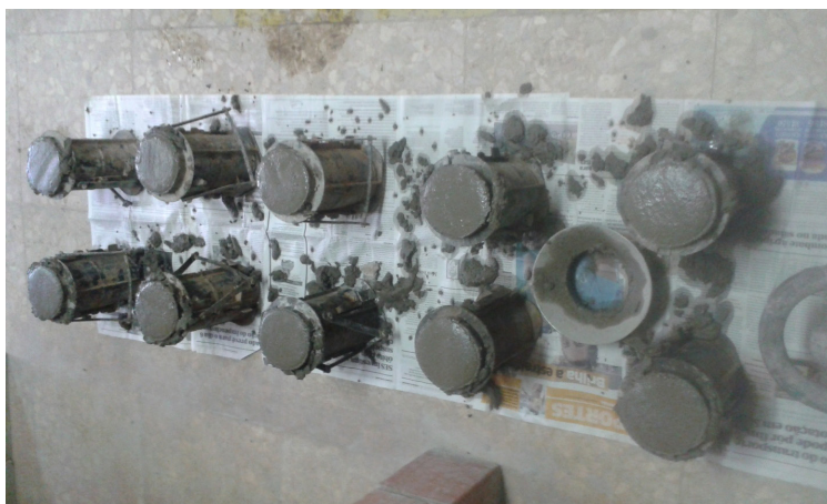
Figura 2: Moldagem de corpos de prova Fonte: Elaborado pelo autor, 2016
