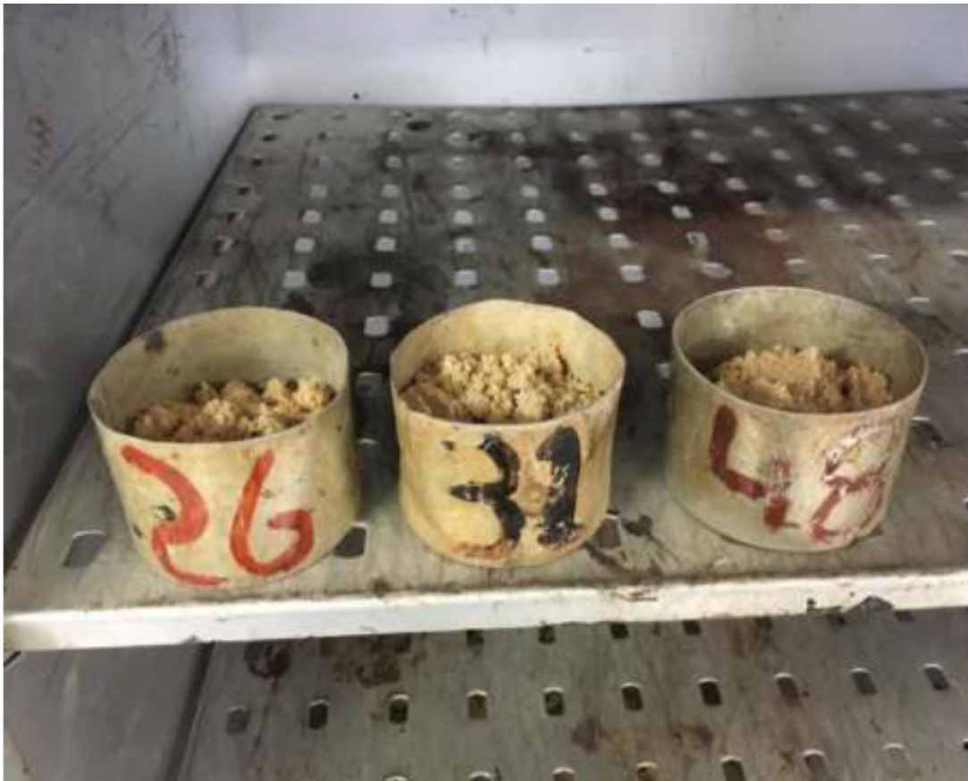
Foto 3 – Cápsulas na estufa para determinação de teores de umidade. (Fonte: acervo do autor )
