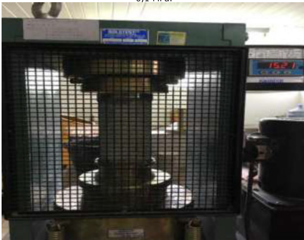
Foto 8 – Ensaio de compressão axial (Fonte: acervo do autor)
