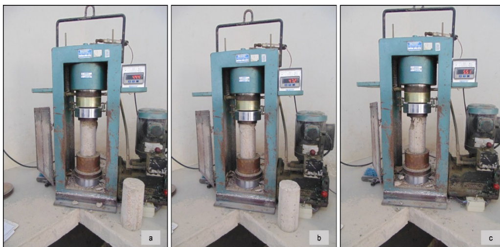
Figura 32 - Ensaio de Resistência a Compressão (Convencional – 14 dias) Fonte: Autores (2016)
