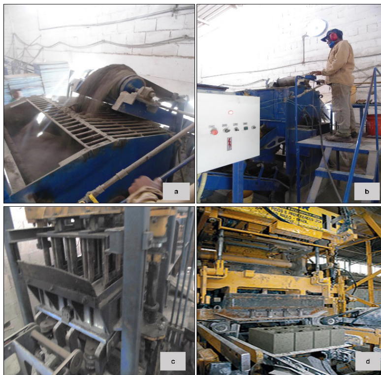
Figura 38 – Misturador e Prensa do Material Autor: Autores: 2016
