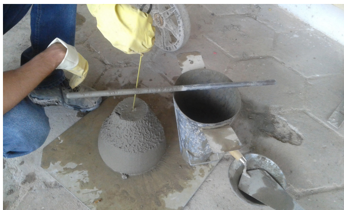
Figura: 5 Teste de abatimento Fonte: Elaborado pelo autor, 2016.
