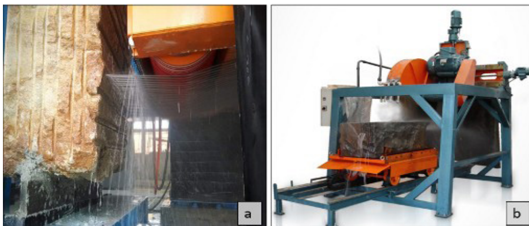
Figura 13 – Equipamentos de corte: a) Tear multifios; b) Talha-blocos Fonte: http://hedel.ind.br/images/190/multi-fios-cortando-granito.jpg
