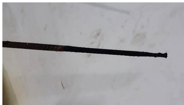
Figura 7 – Barra após 8h de corrosão acelerada (perda notável de seção e nervura)
