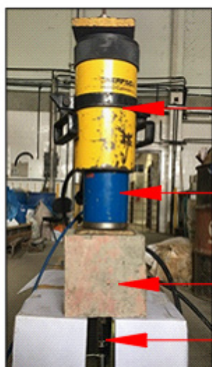
Figura 6 – Preparo para o Pull Out Test (POT): (a) Dimensões da fôrma para o corpo-de-prova conforme recomendações RILEM (1983). (b) CPs no processo de cura após concretagem; e (c) Localização dos equipamentos para medição da carga e do deslizamento da barra ancorada nos CPs
